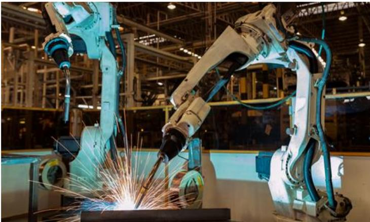
**Gambar III.9** Aplikasi Robot untuk *Welding*
