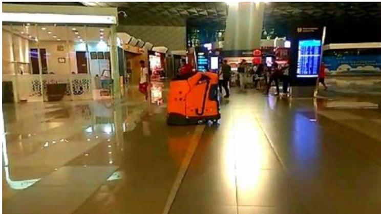
**Gambar III.1** *Robotic Scrubber Drier* yang Bisa Dioperasikan secara Otonom di Terminal 3 Bandara Soekarno-Hatta
